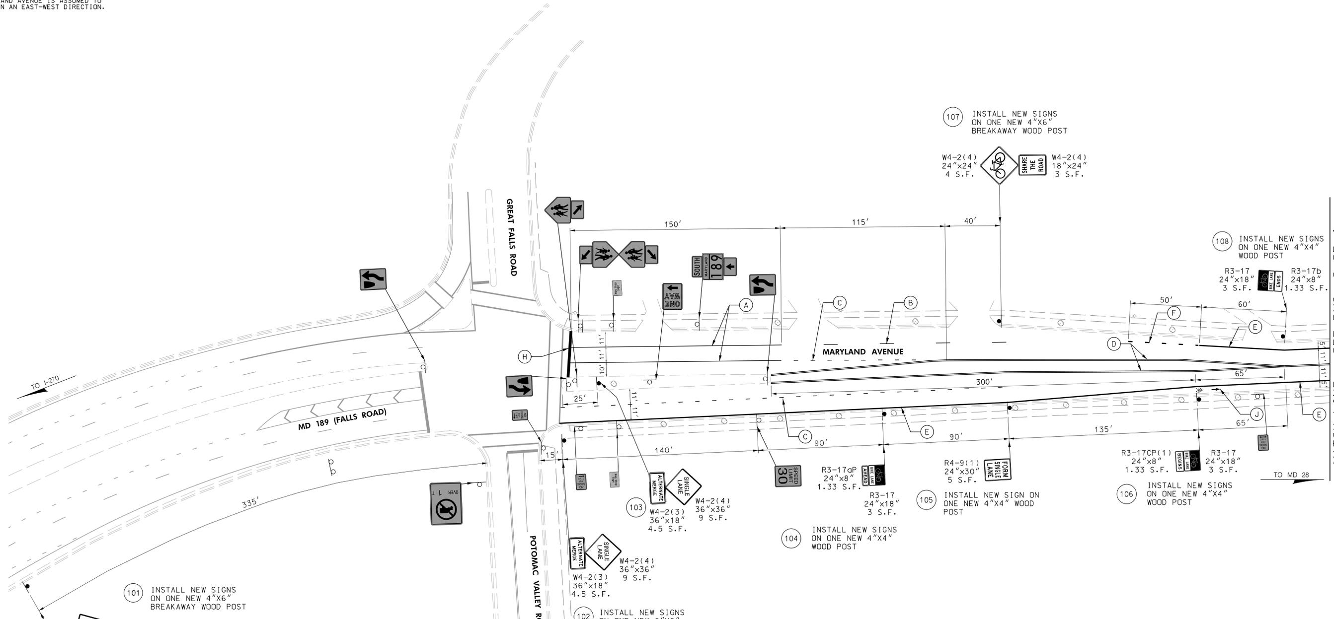
107 INSTALL NEW SIGNS ON ONE NEW 4"x6" BREAKAWAY WOOD POST
